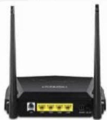
a) Modem ADSL; cổng bên trái dùng cho cáp ADSL với đầu cáp kiểu cáp điện thoại
